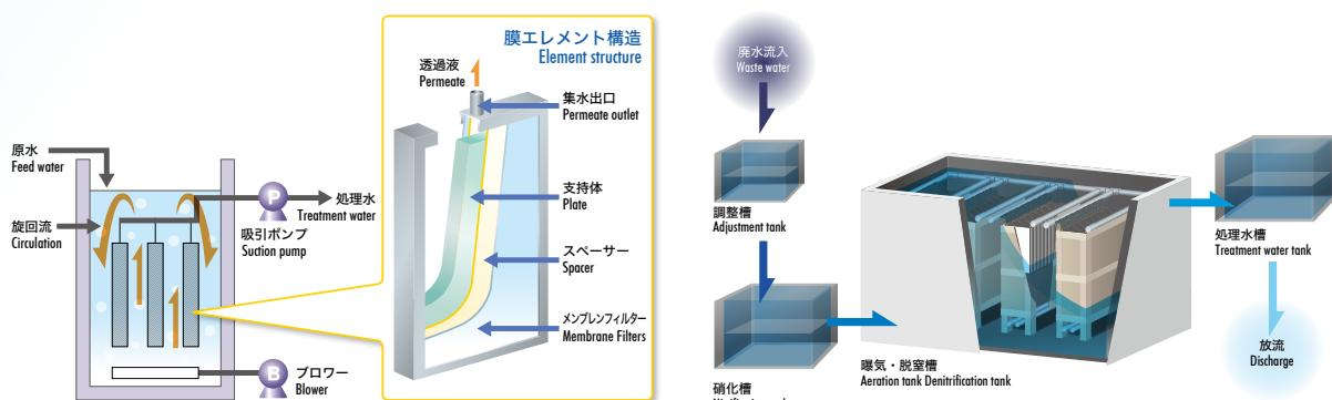
浸漬型膜モジュールは、膜エレメントを水槽内に浸漬し、吸引又は重力によるろ過を行います。膜面では懸濁粒子がダイナミックろ過層を形成、さらに槽内下部からのエアレーション洗浄が膜の閉塞を防ぐため、高濃度排水中の長期運転が可能になります。
